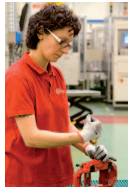
Stabilimento Auto di Curno (Italia). Montaggio di una pinza.
