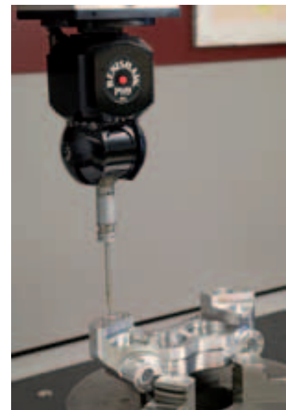
Stabilimento Racing di Curno. Controllo prima lavorazione pinza con macchina tridimensionale.
