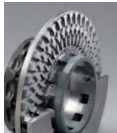
Veicoli industriali. Disco freno autoventilato Star Pillar per Iveco Starlis.
