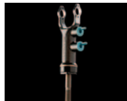
Auto racing. Pompa in alluminio ricavata dal pieno, 2001.
