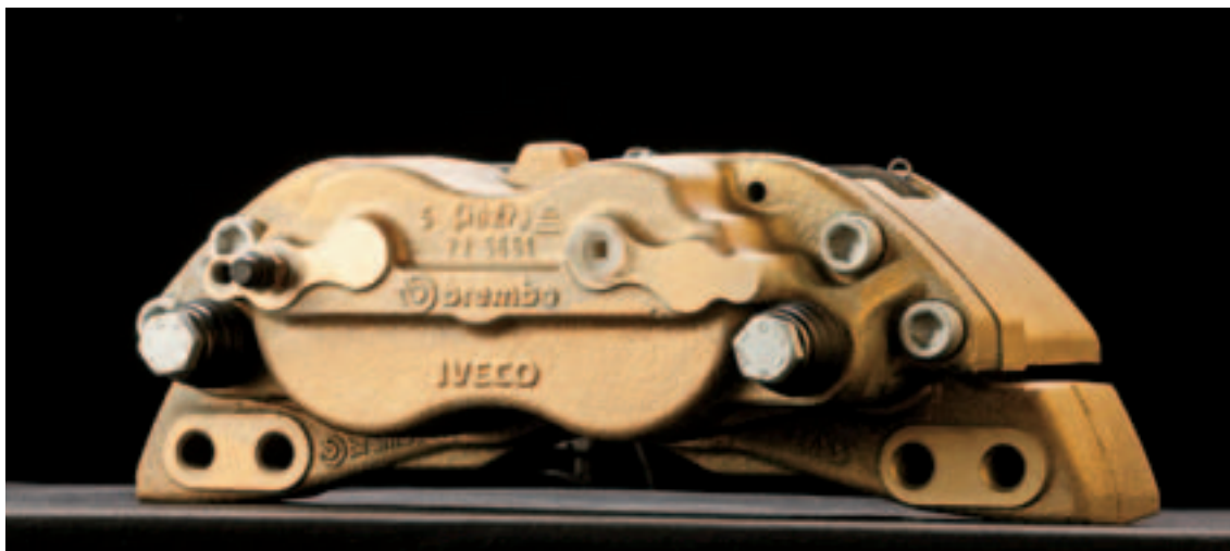
Veicoli commerciali. Pinza flottante anteriore in ghisa, 1993.
