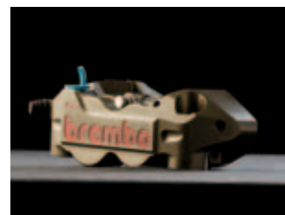
La prima pinza fissa monoblocco con attacchi radiali per Motomondiale Classe 500, 1997.
